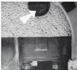
05-2 - BOUCHON DE REMPLISSAGE BOITIER DE DIRECTION SUR CA VERCORS
