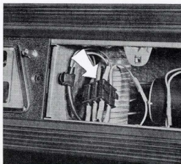
09-7 - EMPLACEMENT DES FUSIBLES CABINE AVANCÉE (VOSGES)
