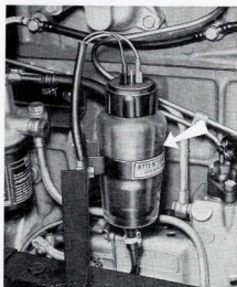
08-11 - RÉSERVOIR DE LIQUIDE DE FREIN SUR CA BASCULA- BLE
